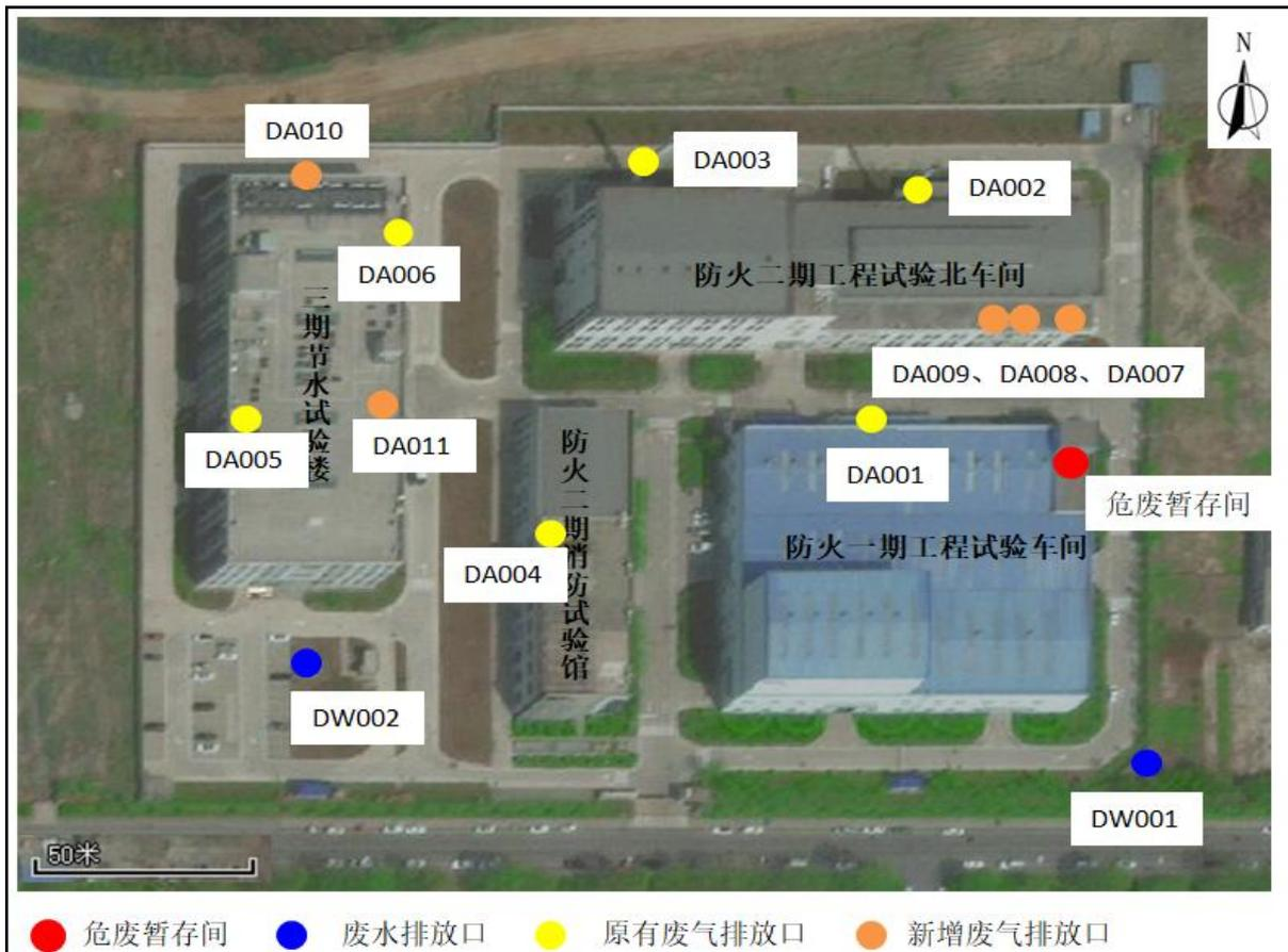
图 1.5-1 项目改扩建工程排气筒位置示意图
